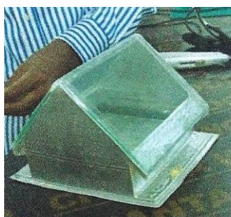
Figura 4: Unidade usada para dessalinização de água do mar
