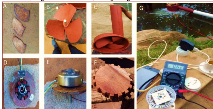
Figura 4: Construção e instalação do sistema. A: Molde das pás; B: rotor pintado; C: turbina pronta; D: estator com as bobinas; E: gerador finalizado; F: engrenagem de madeira; G: sistema instalado no rio.
