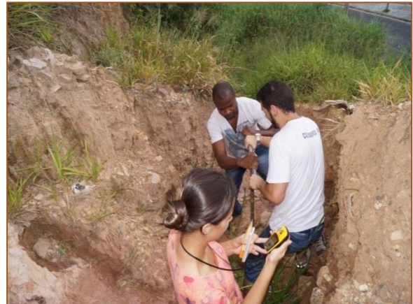
Figura 4: Coleta das coordenadas UTM e elevações através do GPS
