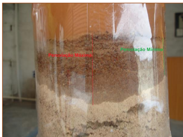
Figura 4: Demonstração da percolação máxima e mínima no simulador.
