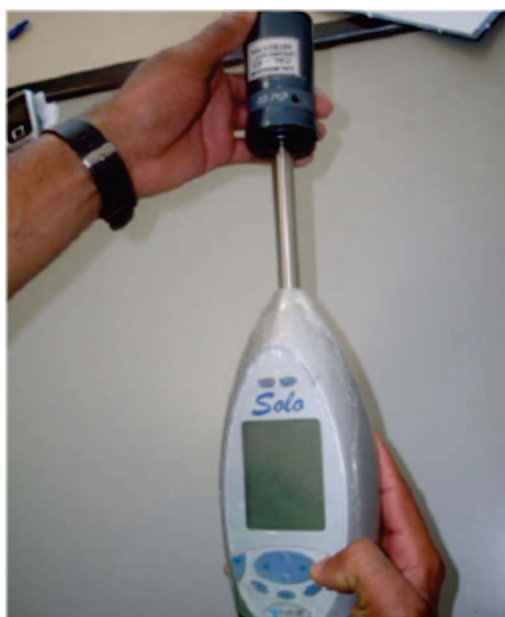
Figura 2.6: Equipamento sendo calibrado com calibrador acústico
