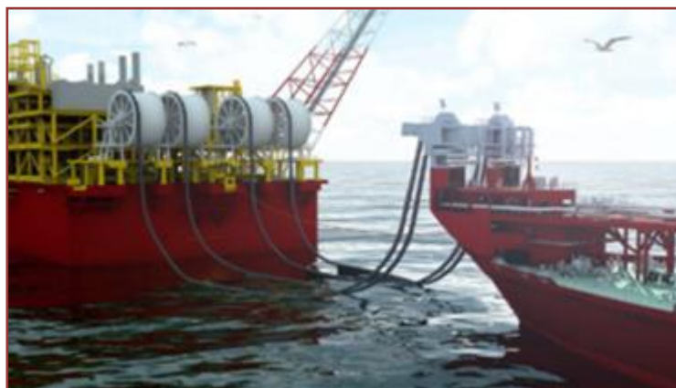
Figura 3 – Método de descarregamento do líquido através de mangueiras criogênicas.
