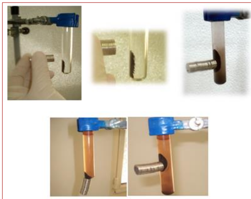
Figura 13 - Resposta magnética das nanopartículas da amostra GM frente ao estímulo de um ímã.
