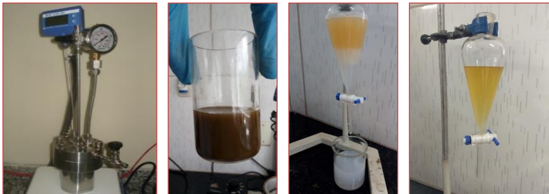
Figura 4: Fotografias (a) do reator de aço inox, (b) da mistura reacional, (c) e (d) funil de decantação para lavagem e separação dos resíduos do biodiesel.
