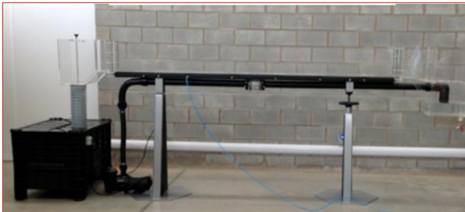
Figura 5: Canal hidráulico utilizado nos testes de medição das vazões com o flowmeter.
