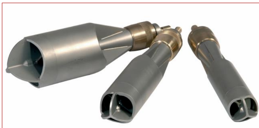
Figura 1: Seção mecânica (hélices) do Continuous Flowmeter da Empresa Halliburton.
