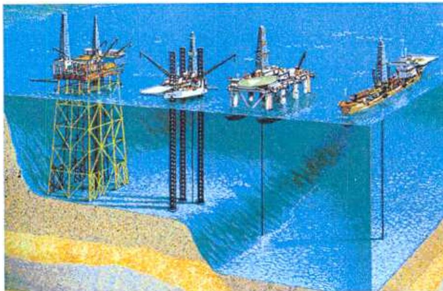
Figura 4.51 – Tipos de sondas marítimas.
