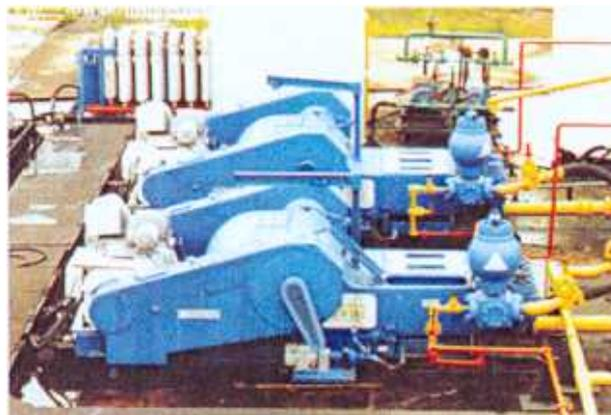
Figura 4.15 – Bombas de lama tipo triplex.
